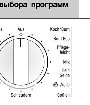
**i** Ручка выбора программ для включения и выключения машины и выбора программы. Можно поворачивать в обоих направлениях.
