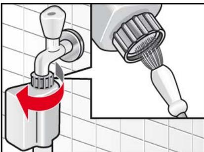
Si l'eau n'arrive pas au lave-linge séchant, ou du moins pas en quantité suffisante, commencez par mettre le flexible d'arrivée d'eau hors pression :
