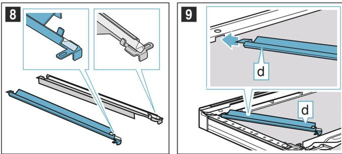
8. Reflektor **d** einsetzen (Bild **10**).
