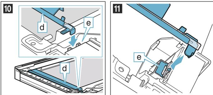
10. Zweiten Reflektor rechts wie den linken Reflektor einsetzen.
