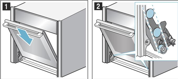
3. Drehen Sie den Türgriff etwas nach oben **a**, damit die Gerätetür vollständig nach unten rutscht **b** (Bild **3**).
