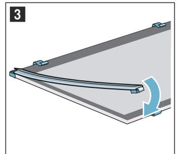
3. Zwischenscheibe mit Dichtungen und Abstandshalter einsetzen. Der Pfeil auf der Zwischenscheibe muss mit dem Pfeil auf dem Rahmen übereinstimmen (Bild **4**).
