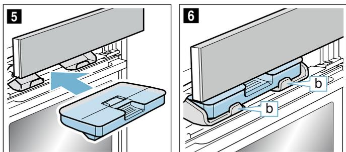
9. Pousser lentement le bandeau vers le bas, puis vers l'arrière jusqu'à ce qu'il soit entièrement fermé. Le réservoir d'eau est rempli. Vous pouvez démarrer des modes avec de la vapeur.
