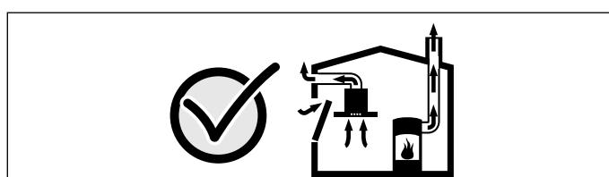
В любой ситуации обращайтесь за советом к компетентному лицу, ответственному за эксплуатацию и очистку труб, способному оценить вентиляционную систему всего дома и предложить Вам решение по принятию соответствующих мер. Если вытяжка работает исключительно в режиме циркуляции воздуха, то эксплуатация возможна без ограничений.
