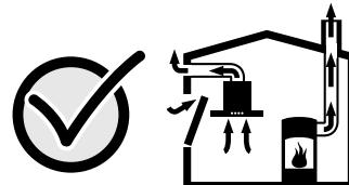
В любой ситуации обращайтесь за советом к компетентному лицу, ответственному за эксплуатацию и очистку труб, способному оценить вентиляционную систему всего дома и предложить Вам решение по принятию соответствующих мер. Если вытяжка работает исключительно в режиме циркуляции воздуха, то эксплуатация возможна без ограничений.
