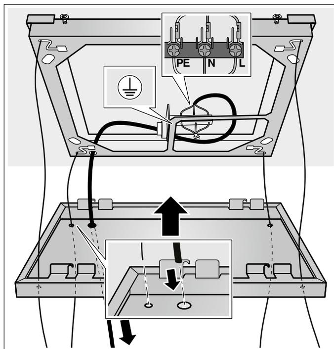
2. Suspendez le capot du cadre sur les 4 vis sur le bord du cadre.
