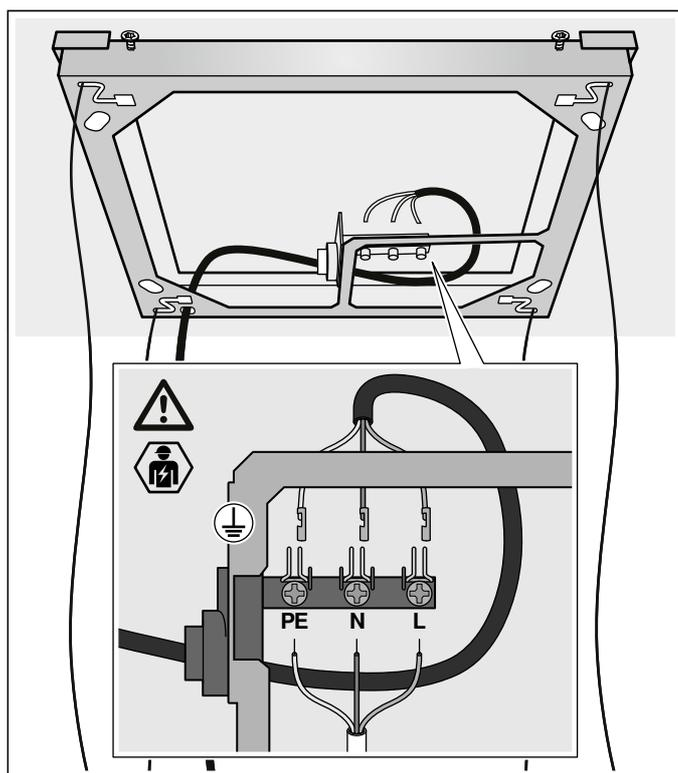
5. Réalisez le raccordement électrique.
