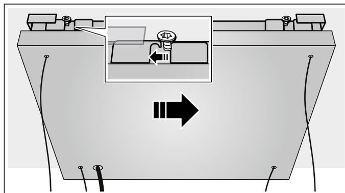
3. Serrez les vis sur le bord du cadre.
