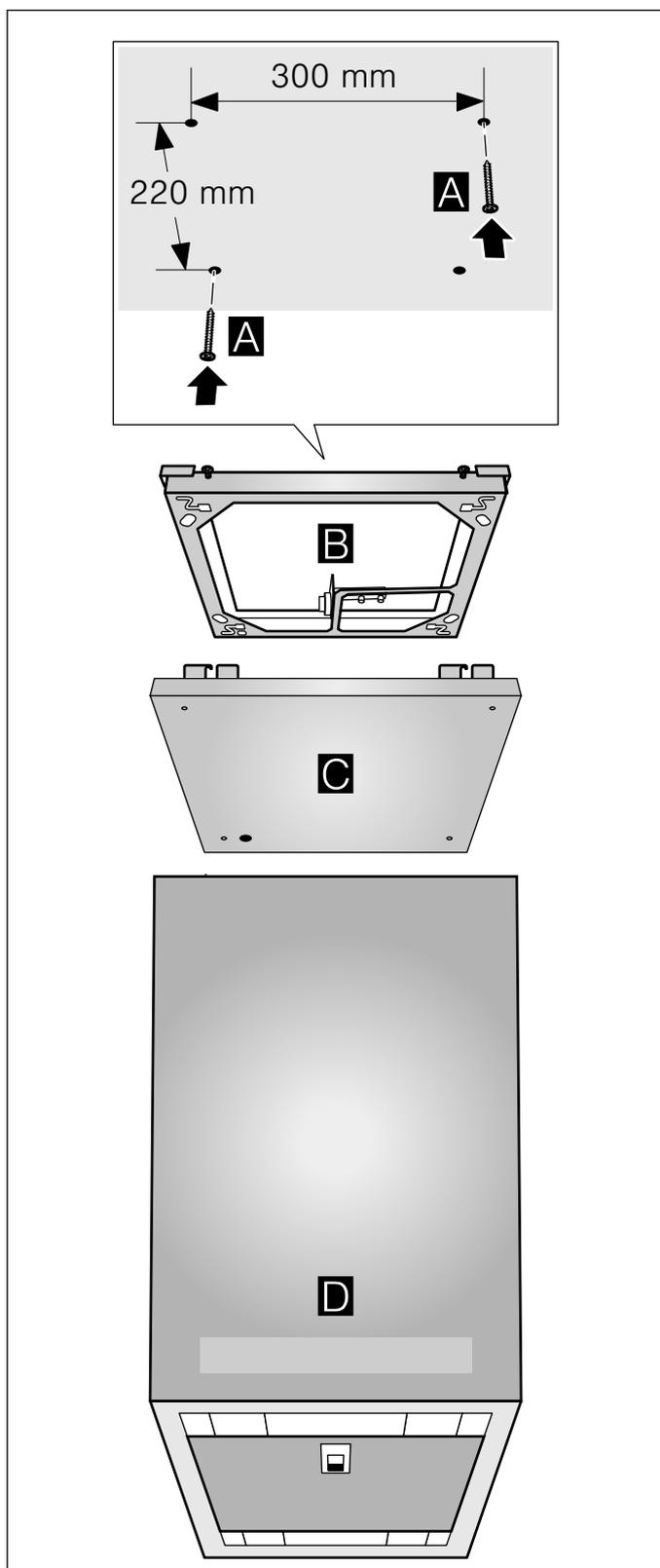
2. Insérez les deux vis sur le capot par les ouvertures prévues dans le cadre **A**. Déplacez le cadre de façon à ce que les vis puissent être vissées dans les trous de fixation **B**.
