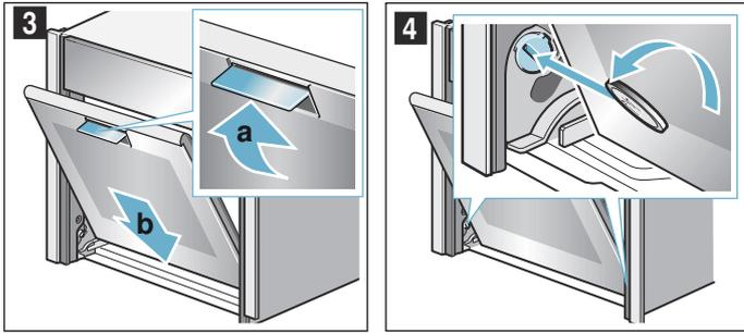
Левый фиксатор: против часовой стрелки
