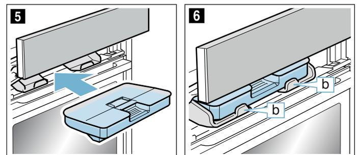
9. Медленно передвиньте панель вниз, затем отожмите её назад, пока она полностью не закроется. Резервуар наполнен. Теперь можно запустить режим с использованием пара.
