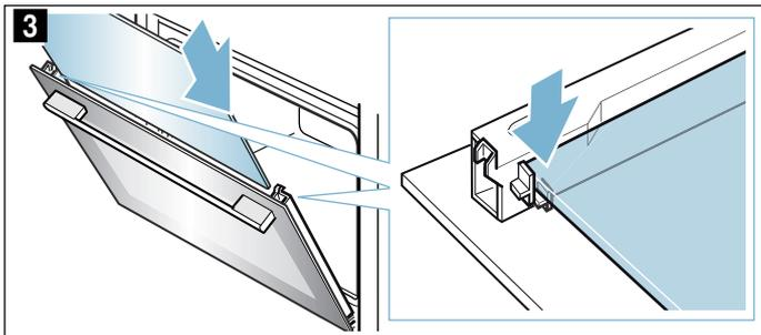
4. Insérer la vitre extérieure en veillant à ce que la vitre soit bien en place dans le support inférieur (fig. 4).
