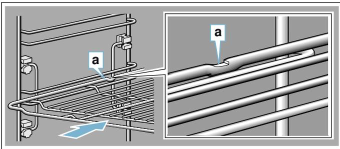
Al introducir las bandejas, asegurarse de que la muesca de enganche **a** se encuentre en la parte trasera y señale hacia abajo. El desnivel de los accesorios **b** debe señalar por delante hacia la puerta del aparato.
