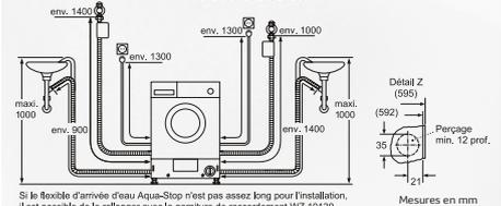
Si le flexible d'arrivée d'eau Aqua-Stop n'est pas assez long pour l'installation, il est possible de le rallonger avec la garniture de raccordement WZ 10130 (longueur 2,5 m).
