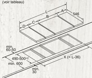
Pour le montage de plusieurs éléments côte à côte, plusieurs kits de montage sont nécessaires (Z9914X0).
