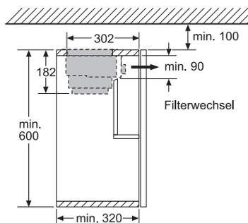
Montage Gerät mit Clean Air Modul
