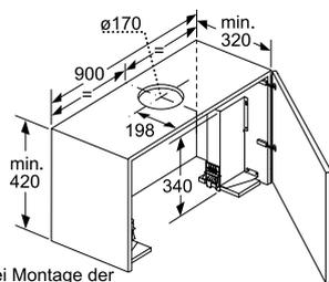
Bei Montage der 90cm Flachschrümhaube in einen 90cm breiten Oberschrank ist ein Montage-Set erforderlich. Die beiden Montagewinkel werden rechts und links im Möbel verschraubt. Montage nach Schablone.
