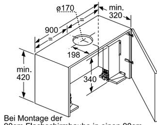
Bei Montage der 90cm Flachschirmhaube in einen 90cm breiten Oberschrank ist ein Montage-Set erforderlich. Die beiden Montagewinkel werden rechts und links im Möbel verschraubt. Montage nach Schablone. Maße in mm
