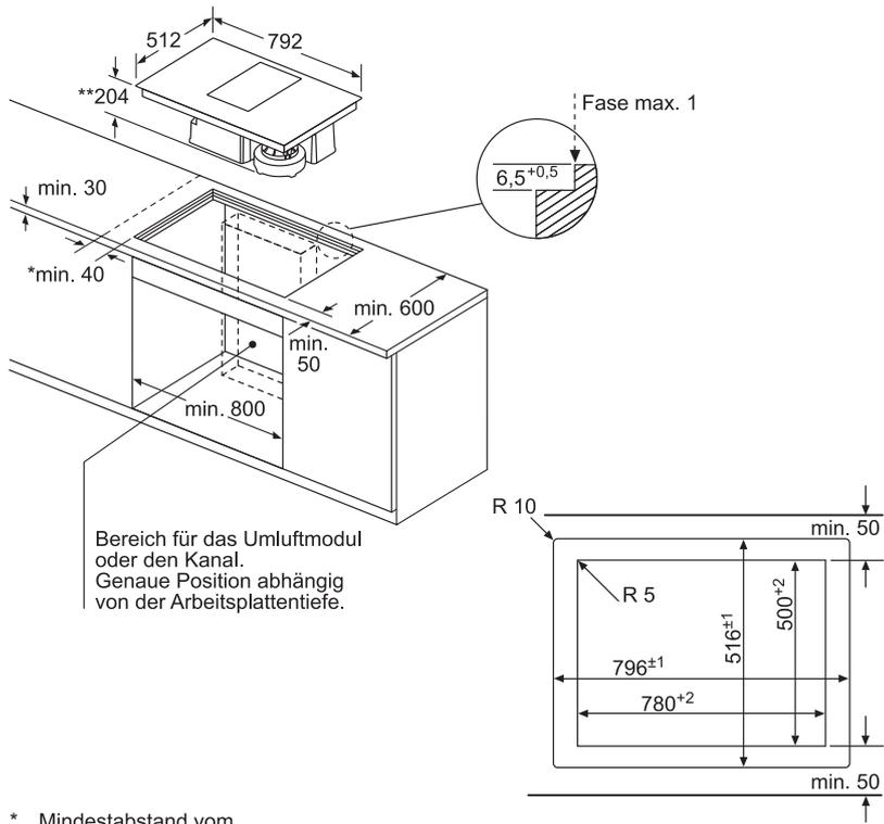
Bereich für das Umluftmodul oder den Kanal.
