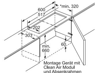
Montage Gerät mit Clean Air Modul und Absenkrahmen
