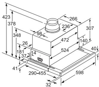
Tiefenanpassung des Filterauszuges bis 29 mm möglich
