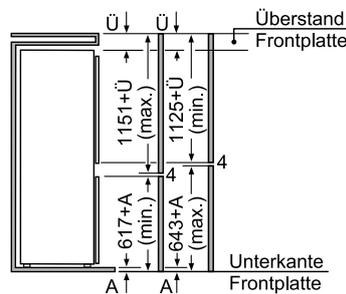
Die angegebenen Möbeltürmaße gelten für eine Türfuge von 4 mm. Bei Verwendung einer anderen Fugenbreite (max.14 mm) müssen die Maße angepasst werden.
