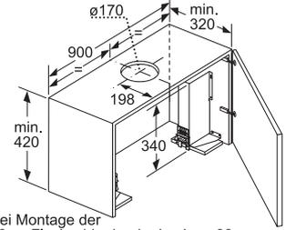
Bei Montage der 90cm Flachschrümhaube in einen 90cm breiten Oberschrank ist ein Montage-Set erforderlich. Die beiden Montagewinkel werden rechts und links im Möbel verschraubt. Montage nach Schablone.
