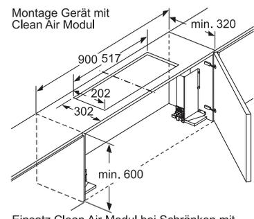
Einsatz Clean Air Modul bei Schränken mit Quertraverse (Lifttür) nicht möglich.
