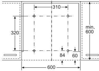
Montage Gerät mit Absenkrahmen
