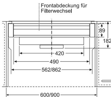
Frontabdeckung für Filterwechsel
