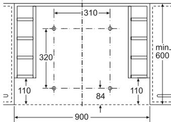
Montage Gerät mit Absenkrahmen
