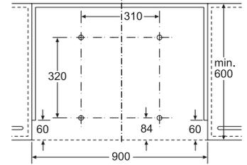
Montage Gerät mit Absenkrahmen
