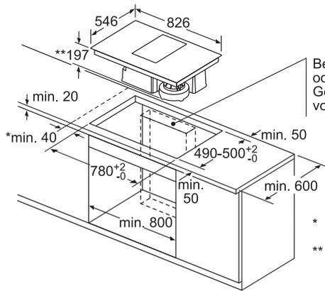
Bereich für das Umluftmodul oder den Kanal.
