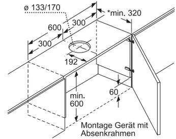
Montage Gerät mit Absenkrahmen
