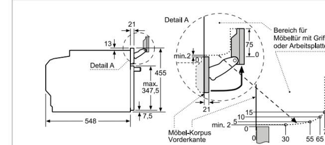
Wird das Kompaktgerät unter einem Kochfeld eingebaut, muss folgende Arbeitsplattenstärke (ggf. inkl. Unterkonstruktion) beachtet werden.
