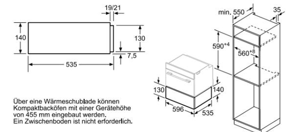
Über eine Wärmeschublade können Kompaktbacköfen mit einer Gerätehöhe von 455 mm eingebaut werden. Ein Zwischenboden ist nicht erforderlich.
