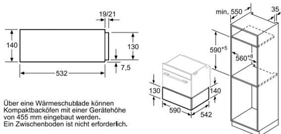
Über eine Wärmeschublade können Kompaktbacköfen mit einer Gerätehöhe von 455 mm eingebaut werden. Ein Zwischenboden ist nicht erforderlich.
