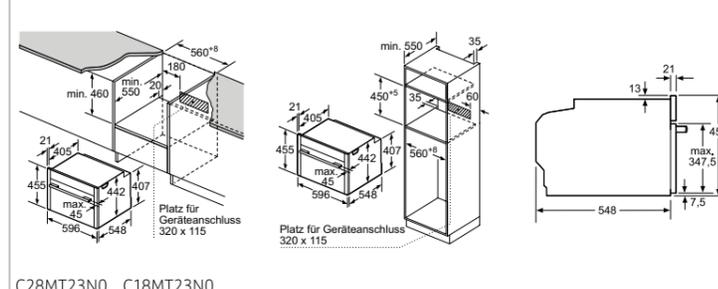
Wird das Kompaktgerät unter einem Kochfeld eingebaut, muss folgende Arbeitsplattenstärke (ggf. inkl. Unterkonstruktion) beachtet werden.
