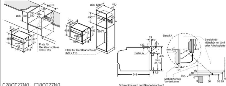
Wird das Kompaktgerät unter einem Kochfeld eingebaut, muss folgende Arbeitsplattenstärke (ggf. inkl. Unterkonstruktion) beachtet werden.
