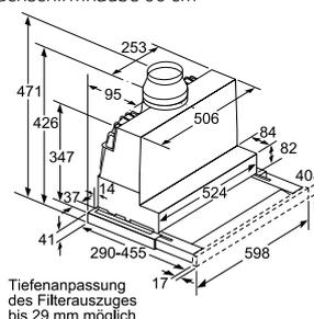
Tiefenanpassung des Filterauszuges bis 29 mm möglich
