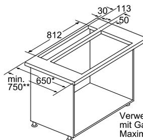
Verwendung mit Gaskochfeld: Maximalleistung gesamt 12,4 kW
