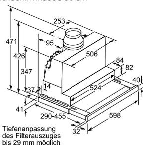
Tiefenanpassung des Filterauszuges bis 29 mm möglich
