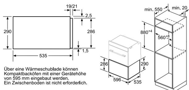
Über eine Wärmeschublade können Kompaktbacköfen mit einer Gerätehöhe von 595 mm eingebaut werden. Ein Zwischenboden ist nicht erforderlich.
