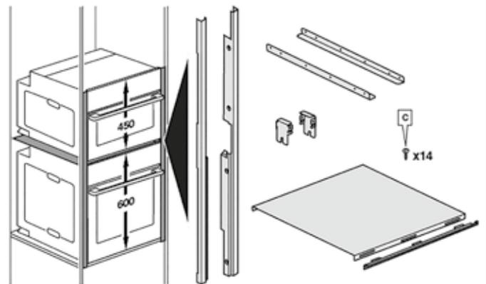
Durchgehende Design-Lisenen zur nahtlosen Kombination eines Slide&Hide-Backofens mit einem Compact-Backofen + Zwischenboden zur Kombination von zwei Backöfen
