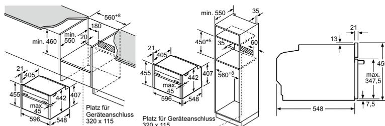
Wird das Kompaktgerät unter einem Kochfeld eingebaut, muss folgende Arbeitsplattenstärke (ggf. inkl. Unterkonstruktion) beachtet werden.
