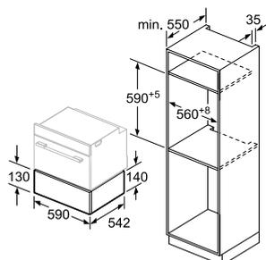
Über eine Wärmeschublade können Kompaktbacköfen mit einer Gerätehöhe von 455 mm eingebaut werden. Ein Zwischenboden ist nicht erforderlich.
