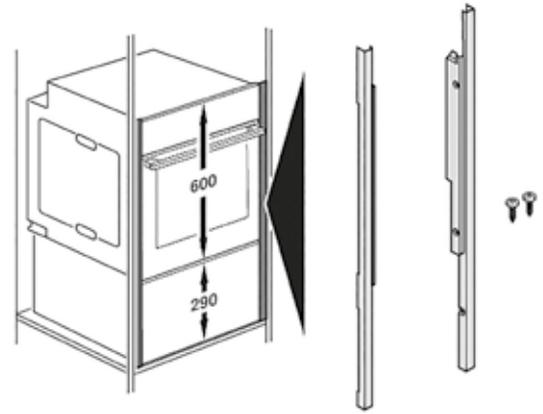
Durchgehende Design-Lisenen zur nahtlosen Kombination eines Backofens mit einer Wärmeschublade (290mm)
