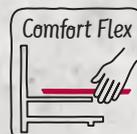
Ces rails coulissent complètement hors du four mais sans jamais basculer. Ils disposent de butées à l'arrière qui les bloquent. Pratiques, ils se clipsent et se déclipsent aisément pour se positionner au niveau de votre choix.
