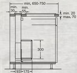
Son utilisation avec une table de cuisson à gaz est possible uniquement en activant la hotte de ventilation. Puissance maximale totale 13,4 kW.
