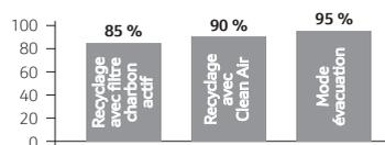
Mesures réalisées selon la norme européenne IEC - 61591:1997+A1:2005
