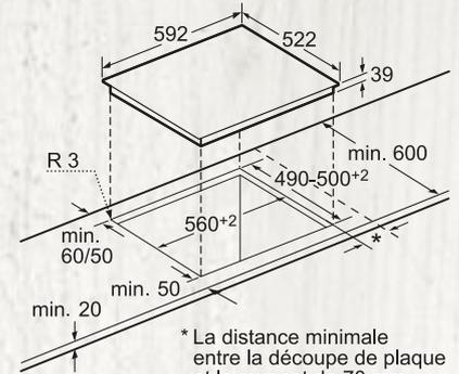
\* La distance minimale entre la découpe de plaque et le mur est de 70 mm
