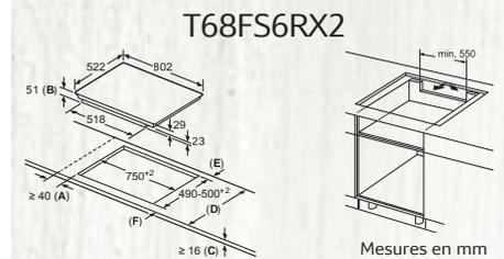
A : Distance minimum entre la découpe de la plaque de cuisson et le mur.
