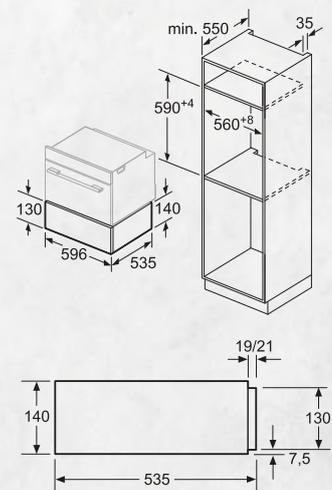
Il est possible d'installer des fours compacts d'une hauteur de 455 mm sur un tiroir chauffant. Aucun faux-plancher n'est nécessaire.
