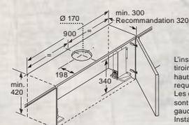
L'installation en fixe d'une hotte tirée de 90 cm dans un meuble haut d'une largeur de 90 cm requiert un kit d'installation. Les deux équerres d'installation sont vissées à droite et à gauche dans le meuble. Installation selon gabarit.
