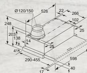
La profondeur du tiroir peut s'ajuster jusqu'à 29 mm. Mesures en mm
