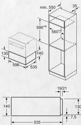
Il est possible d'installer des fours compacts d'une hauteur de 455 mm sur un tiroir chauffant. Aucun faux-plancher n'est nécessaire.
