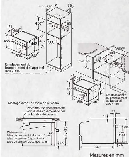
Si l'appareil est installé sous une table de cuisson, les épaisseurs de plaque de travail suivantes (le cas échéant y compris la sous-structure) doivent être respectées.
