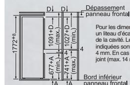
Pour les dimensions supérieures (1780-1790), un linteau d'écartement doit être prévu au plafond de la cavité. Les dimensions de porte de meuble indiquées sont valables pour un joint de porte de 4 mm. En cas d'utilisation d'une autre largeur de joint (max. 14 mm) les cotes doivent être adaptées.
