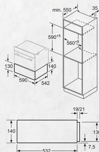
Il est possible d'installer des fours compacts d'une hauteur de 455 mm sur un tiroir chauffant. Un fond intermédiaire n'est pas nécessaire.
