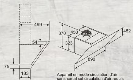
Appareil en mode circulation d'air sans canal set circulation d'air requis
