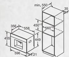
Les réservoirs à grains et à eau se retirent par l'avant. Hauteur de montage recommandée 95-145 cm.
