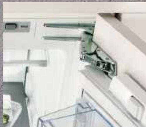
Grâce aux charnières avec amortisseur intégré, la porte se ferme en douceur, en silence et automatiquement dès 20°. Son angle d'ouverture, extra-large, se règle jusqu'à 115°.
