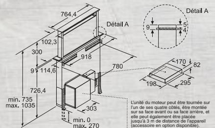
L'unité du moteur peut être tournée sur l'un de ses quatre côtés, être montée sur sa face avant ou sa face arrière, et elle peut également être placée jusqu'à 3 m de distance de l'appareil (accessoire en option disponible).
