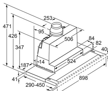
Tiefenanpassung des Filterauszuges bis 29 mm möglich
