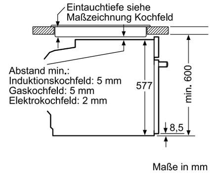
Wird das Gerät unter einem Kochfeld eingebaut, muss folgende Arbeitsplattenstärke (ggf. inkl. Unterkonstruktion) beachtet werden.
