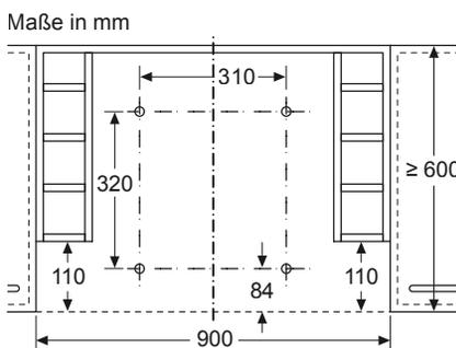
Montage Flachschirmhaube mit Absenkrahmen
