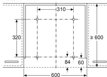
Montage Flachschirmhaube mit Absenkrahmen
