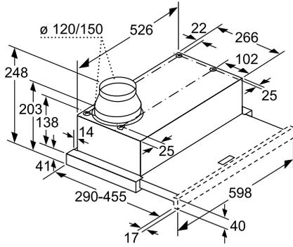
Tiefenanpassung des Filterauszuges bis 29 mm möglich
