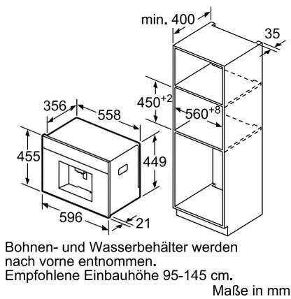
Bei Verwendung der 92° Scharnierbegrenzung (Ersatzteilnr. 00636455) beträgt der Mindestabstand zur Wand nur 100 mm.
