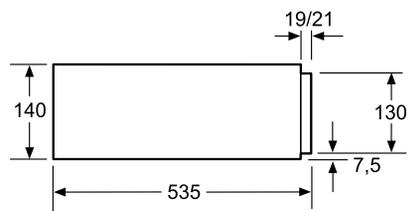
Über eine Wärmeschublade können Kompakt-Backöfen mit einer Gerätehöhe von 455 mm eingebaut werden. Ein Zwischenboden ist nicht erforderlich.
