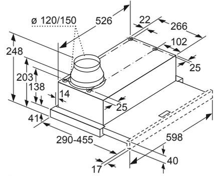
Tiefenanpassung des Filterauszuges bis 29 mm möglich
