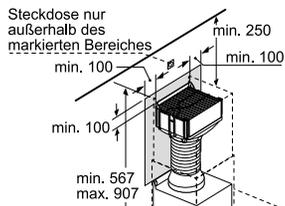
Montage mit Umluftschlitzen nach unten.
