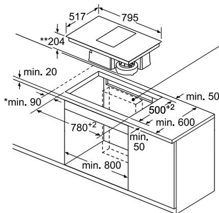
Bereich für das Umluftmodul oder den Kanal. Genaue Position abhängig von der Arbeitsplattentiefe.
