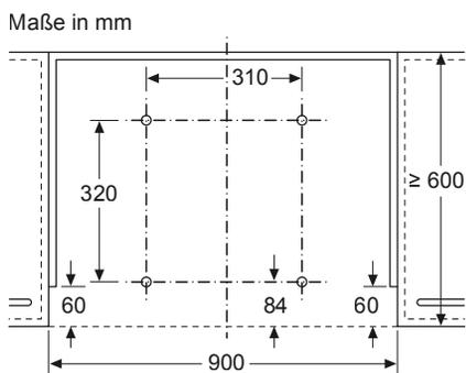
Montage Flachschirmhaube mit Absenkrahmen
