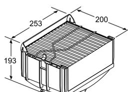
Bei Montage auf Lüfterkasten Umluftmodul um 180° drehen. Steckdose nur außerhalb des markierten Bereiches
