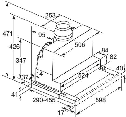
Tiefenanpassung des Filterauszuges bis 29 mm möglich
