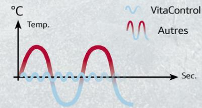
Vita Control, maintient une température constante dans le réfrigérateur et le congélateur. Les aliments restent frais plus longtemps, la glace n'est jamais trop froide ou trop molle. Renseigné par 2 sondes intérieures et 1 extérieure, le compresseur - technologie Inverter - anticipe tout changement de température et fonctionne de façon linéaire, diminuant par le même coup la consommation électrique.
