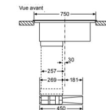
En cas d'installation directement contre des murs extérieurs qui ne sont pas isolés (μ ≥ 0,5 W/m² °C), nous recommandons d'utiliser des configurations de recyclage partiellement ou totalement gainées.
