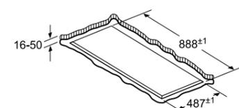
Ne pas monter directement sur un faux plafond constitué de plaques de plâtres ou d'un matériaux de construction léger similaire. Il est impératif d'utiliser un support adapté et solidement fixé dans la dalle en béton.
