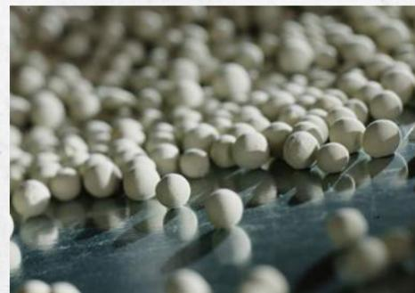
Ce minéral naturel, intégré dans la cuve de l'appareil, absorbe l'humidité et la transforme en chaleur sèche. Résultat : un séchage économique et ultra performant. La technologie de séchage par Zeolith® a été primée en Allemagne pour sa haute performance énergétique.
