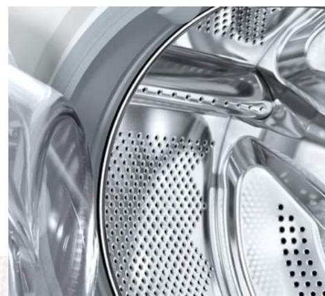
Il est constitué d'aubes asymétriques. Selon le programme choisi, le tambour tourne dans un sens ou l'autre, brassant le linge robuste énergiquement, principalement avec le côté plat des aubes et le linge délicat en douceur, principalement avec leur côté arrondi. Pour accentuer l'effet, la structure "gouttes d'eau" du tambour reprend le profil des aubes.
