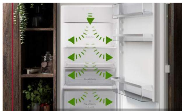
Grâce aux ouvertures pratiquées dans les parois du réfrigérateur et du congélateur, la répartition du froid est encore optimisée, même dans les moindres recoins. Après ouverture de la porte, la température redescend trois fois plus vite que dans un appareil à froid statique. Les mets à température ambiante refroidissent plus vite. Le système Multi Air flow réduit aussi les odeurs dans la partie No Frost du congélateur.
