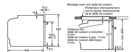
Si l'appareil est installé sous une table de cuisson, les épaisseurs de plaque de travail suivantes (le cas échéant y compris la sous-structure) doivent être respectées.
