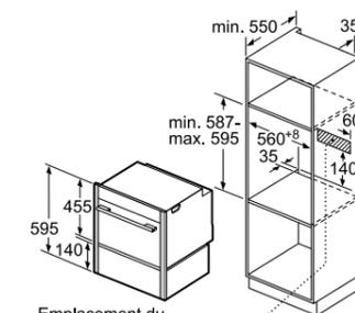
Emplacement du branchement de l'appareil 320 x 115
