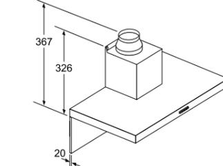
Pour l'utilisation d'une paroi arrière, tenir compte de la conception de l'appareil. Mesures en mm
