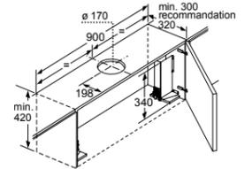
Le montage de la hotte tiroir de 90 cm dans un meuble haut de 90 cm de large requiert un kit de montage. Les deux angles de montage sont vissés à gauche et à droite dans le meuble. Montage selon gabarit.
