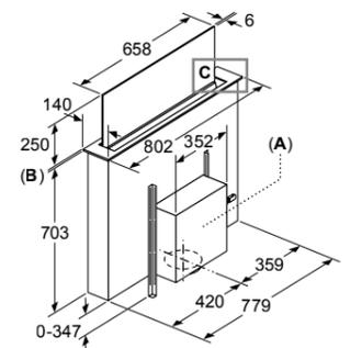
A : Le moteur peut être placé sur l'avant ou l'arrière ou bien être déporté (avec accessoire en option)
