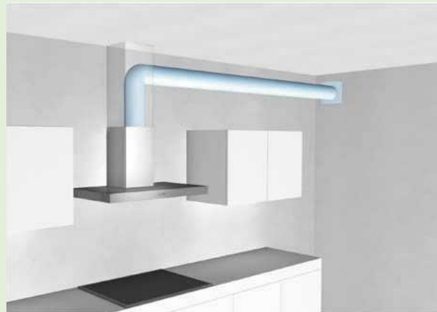
Beispiel einer guten Verrohrung
