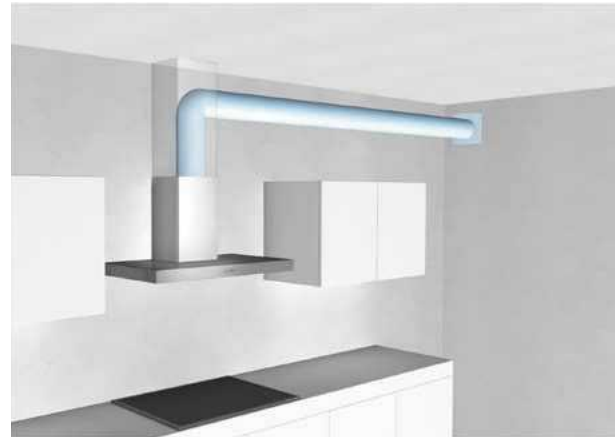
Beispiel einer guten Verrohrung
