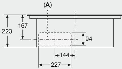
A: Direkt an der Rückseite angeschlossen
