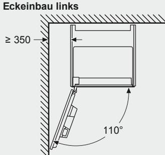
Bei Verwendung des 92°-Scharnierbegrenzers beträgt der min. Abstand zur Wand nur 100 mm
