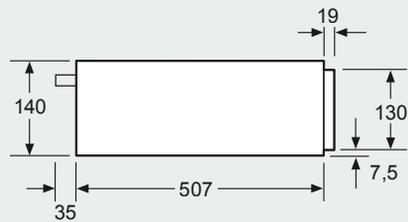
Über eine Vakuumschublade können Kompakt-Backöfen mit einer Gerätehöhe von 455 mm eingebaut werden. Ein Zwischenboden ist nicht erforderlich.
