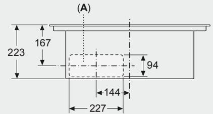
**A:** Direkt an der Rückseite angeschlossen
