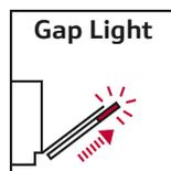
Ein seitliches Licht zeigt an, dass gerade ein Programm läuft. Öffnet man die Tür und stoppt den Spülvorgang, blinkt das Licht. Gap Light in Kombination mit Vario Scharnier macht den Einbau von voll integrierbaren Geschirrspülern in modernen Küchen mit langen, extra dicken Fronten und niedrigen Sockelhöhen perfekt.
