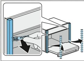
Lösen Sie die montierten Lisenen mit einem Hilfsmittel aus Kunststoff und nehmen Sie sie ab.
