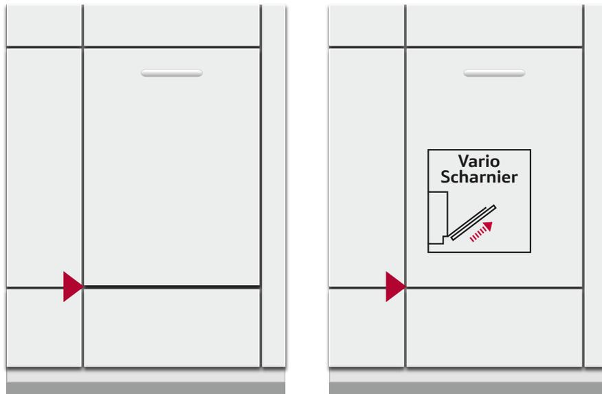
Eine perfekte Lösung für kleinste Spaltmaße zwischen den Möbelfronten bietet das Vario Scharnier. Bei Geräten mit Vario Scharnier verschiebt sich beim Öffnen des Gerätes die vollintegrierte Möbelfront leicht nach oben. Damit sind beim Hocheinbau von Geschirrspülern größere Spaltmaße zwischen den Möbelfronten nicht mehr notwendig.
