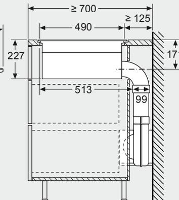
**Beispiel Abluft-Führung in den Boden, Wand**
