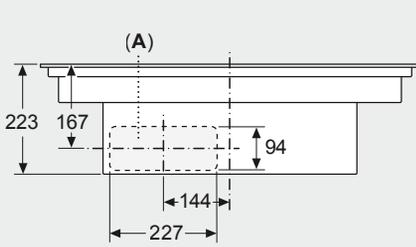
**A:** Direkt an der Rückseite angeschlossen
