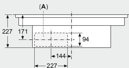
**A:** Direkt an der Rückseite angeschlossen
