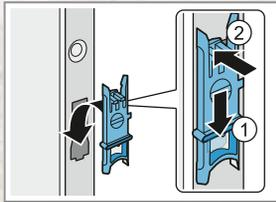
Prüfen Sie, ob die roten Befestigungselemente oben und die grünen Befestigungselemente unten eingehängt und ange-drückt sind.
