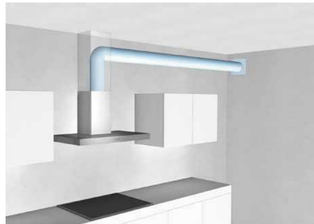
Beispiel einer guten Verrohrung
