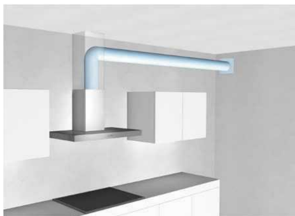
Beispiel einer guten Verrohrung
