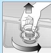
ruotare il cilindro filtri, rimuovere il sistema di filtri ...
