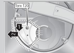
Pulire la pompa di scarico dell'acqua \*
