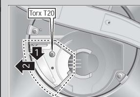
Pulire la pompa di scarico dell'acqua \*
