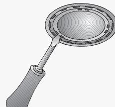
3. Vervang de halogeengloeilamp (gewone halogeengloeilamp, 12 V, max. 20 watt, voetje G4).
