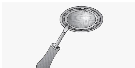
3. Changez l'ampoule halogène (ampoule halogène en vente habituelle dans le commerce, 12 volts, 20 watts maxi., douille G4).
