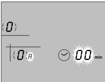
Wenn das Memory-Programm fertig ist, schaltet die Kochstelle aus. Es ertönt eine Minute lang ein Signal. In der Timer-Anzeige blinkt 00. Die Anzeige R der Kochstelle blinkt. In der Kochstellen-Anzeige leuchtet 0. Berühren Sie eine beliebige Bedienfläche. Die Anzeigen erlöschen und der Signaltion verstummt.
