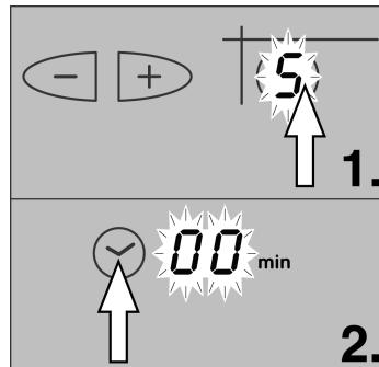
Voer een tijdsduur voor de gewenste kookzone in. Na afloop van de tijdsduur schakelt de kookzone automatisch uit.
