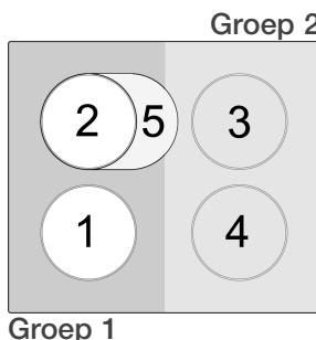
Alle kookzones beschikken over deze functie, met uitzondering van de braadzone als het uitschuifbare gedeelte geactiveerd is. (Zie afbeelding, zone 5)
