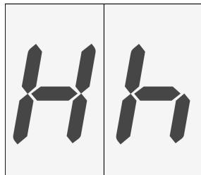
Il piano di cottura è dotato di un indicatore di calore residuo per ciascuna zona di cottura. Tale indicatore segnala quali zone di cottura hanno ancora una temperatura elevata. Pertanto evitare di toccare queste zone di cottura.
