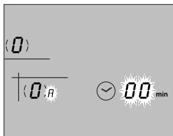
Als het memory-programma klaar is, wordt de kookzone uitgeschakeld. Er klinkt een minuut lang een signaal. In de timer-indicatie knippert 00. De indicatie R van de kookzone knippert. In de kookzone-indicatie verschijnt een 0. Raak een willekeurig bedieningsvlak aan. De indicaties verdwijnen en de signaaltoon houdt op.
