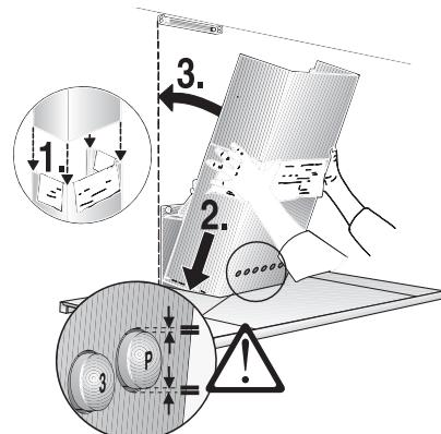
15. Die obere Kaminverblendung vorsichtig nach oben ausziehen und mit 2 Schrauben seitlich an den Haltewinkel schrauben.
