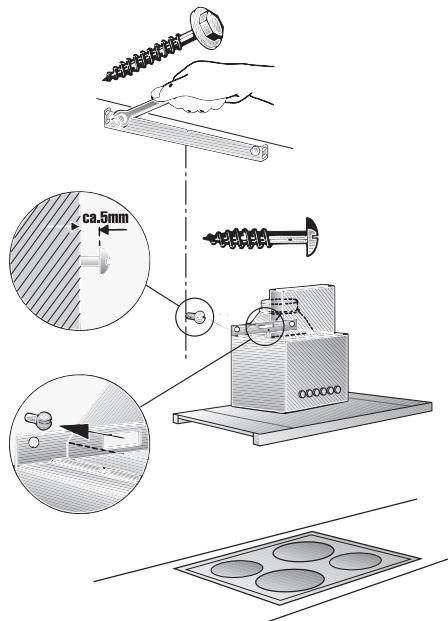
8. 4 Sechskantschrauben mit Unterleg scheiben eindrehen.
