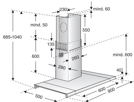
Die Abluft wird über einen Lüftungsschacht nach oben, oder direkt durch die Außenwand ins Freie geleitet.
