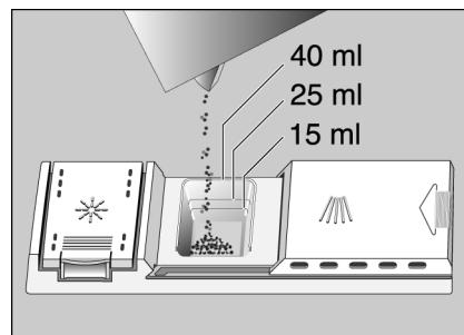
Si le compartiment à détergent [30] est encore fermé, actionnez le verrou d'obturation [28] pour l'ouvrir.
