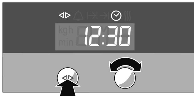
1. Pulsar repetidamente la tecla de las funciones de tiempo hasta que se iluminen los símbolos  $\triangleleft\triangleright$  y  $\odot$ .
