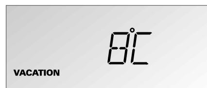
En la pantalla de visualización aparece debajo de la temperatura para la función Eco ajustada de fábrica, la leyenda **VACATION**.
