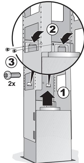
3. Sicherungsbügel einhängen und festschrauben.
