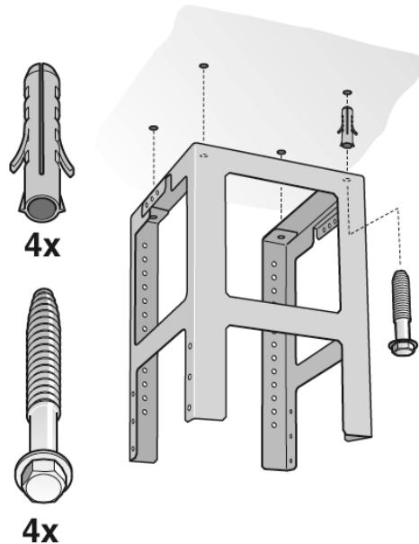
4. 4 Löcher Ø 8 mm bohren und Dübel deckenbündig eindrücken.
