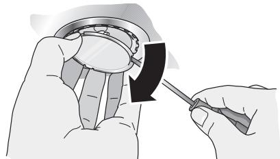
2. Ersetzen Sie die defekte Lampe durch eine neue des gleichen Typs und gleichwertiger Leistung (siehe Typenschild).
