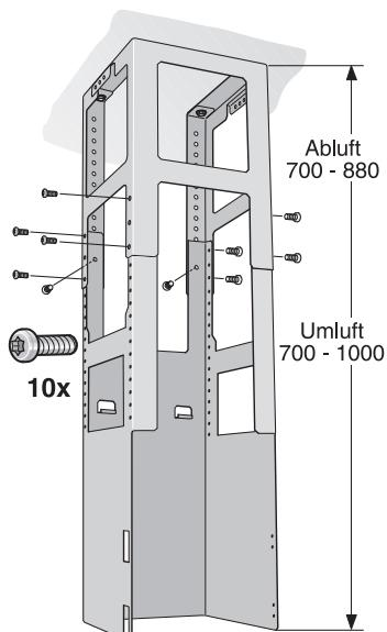
**HINWEIS:** Durch Lösen der Befestigungsschrauben an der Decke, kann das Tragegestell nachträglich ausgerichtet werden.
