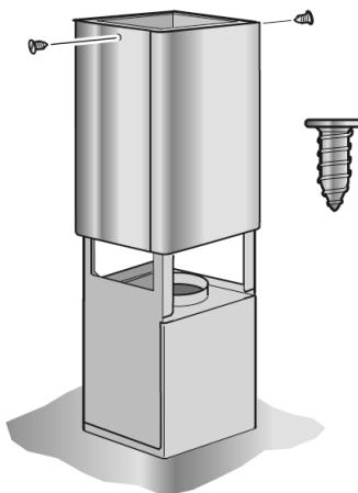
5. Die beiden unteren Teile des Kamins einsetzen und zusammenstecken.
