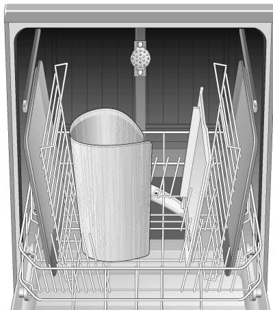
Große Bleche oder Gitter sowie Teller mit einem Durchmesser mehr als 30 cm (Gourmetteller, Pastateller, Platzsteller) können Sie mit Hilfe dieses Sprühkopfes reinigen. Entnehmen Sie hierzu den Oberkorb und setzen Sie den Sprühkopf wie in der Zeichnung dargestellt ein.
