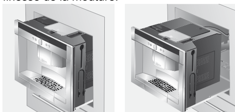
Position d'extraction 1 Position d'extraction 2
