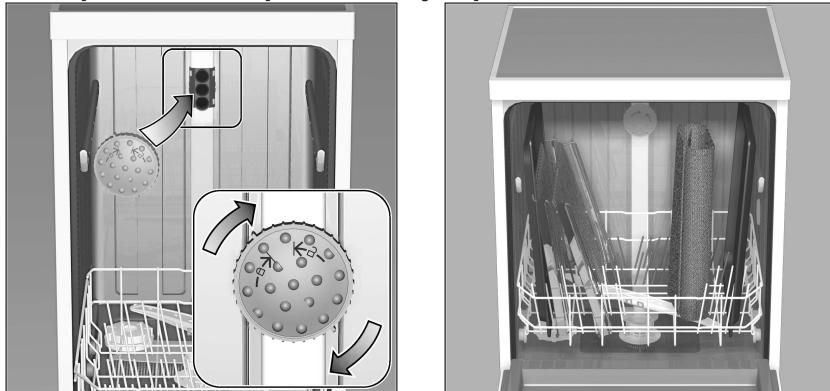
Con este cabezal pulverizador se pueden lavar bandejas pasteleras de gran tamaño, así como platos con un diámetro superior a 30 cm (por ejemplo platos para pasta, etc.). A tal efecto deberá retirarse el cesto superior del lavavajillas, montando el cabezal pulverizador en la máquina tal como se muestra en la ilustración.
