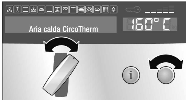
1. Ruotare il selettore delle modalità di funzionamento finché il display di testo non visualizza l'opzione desiderata.
