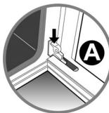
Zum Wiedereinbau der Tür den Vorgang in umgekehrter Reihenfolge durchführen. Sind die Scharniere **B** wieder in den jeweiligen Aufnahmen, Tür ganz öffnen und die Sicherungsstifte der Scharniere durch Absenken der jeweiligen Stifte **A** (pro Scharnier einer) wieder anbringen.
