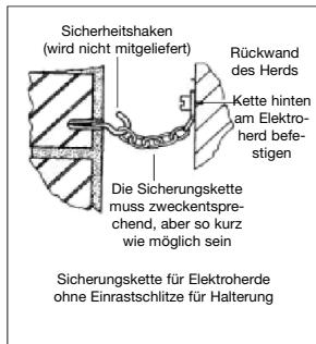
Der Herd ist mit einer Stabilitätssicherung ausgestattet, wie zum Beispiel einer Marken-Sicherungskette (siehe Abbildung), die fest mit der Wand des Raumes verbunden ist.
