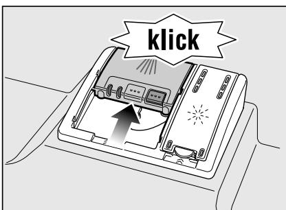
Die Reinigerkammer öffnet sich programmabhängig automatisch zum optimalen Zeitpunkt. Der Pulver- oder Flüssigreiniger verteilt sich im Gerät und wird aufgelöst. Der Tab fällt ins Gerät und löst sich dort auf.
