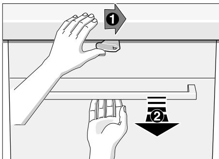
Para abrir la puerta, girar la palanca hacia la derecha y accionar la manilla de apertura de la puerta.
