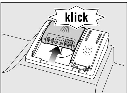
Die Reinigerkammer öffnet sich programmabhängig automatisch zum optimalen Zeitpunkt. Der Pulver- oder Flüssigreiniger verteilt sich im Gerät und wird aufgelöst, der Tab fällt in die Tab-Auffangschale und löst sich dort dosiert auf.
