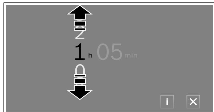
La durée réglée est validée au bout de 3 secondes. La durée s'écoule visuellement dans l'affichage.
