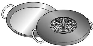
I recipienti con parti di alluminio inserite nella base, riducono l'area ferromagnetica e, pertanto, la potenza fornita può essere inferiore e possono verificarsi problemi di rilevamento, compreso il mancato rilevamento.
