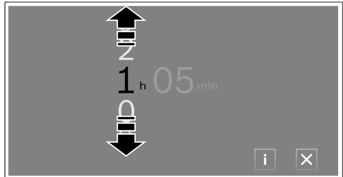
De ingestelde tijdsduur wordt na 3 seconden overgenomen. Op het display kunt u het verloop van de tijdsduur aflezen.
