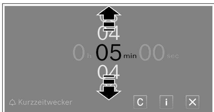
3. Stunden und Sekunden auswählen. Nach oben oder unten gleiten und die gewünschte Dauer einstellen.
