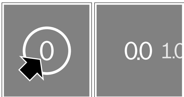
3. Dans les 3 secondes, faire défiler avec le doigt vers la gauche et régler le niveau de puissance désiré. Effleurer le symbole ✓.
