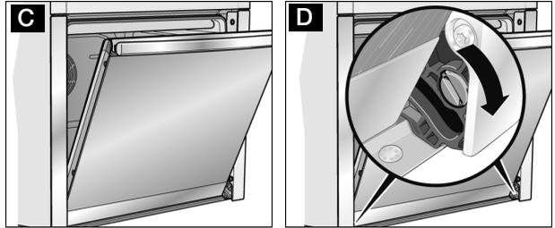
4. Mit einer Münze die beiden Arretierungen der Gerätetür lösen (Bild D).
