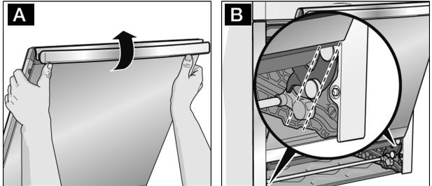
2. Gerätetür gleichzeitig über die Führungsrollen links und rechts einhängen (Bild B).
