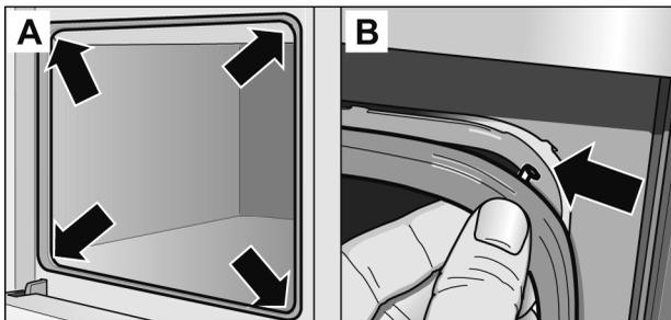
1. Die Haken der Türdichtung (Bild B) an vier Stellen (Bild A) aushängen.
