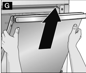
5. Türgriff mit beiden Daumen etwas anheben und die Gerätetür nach oben herausheben (Bild G).
