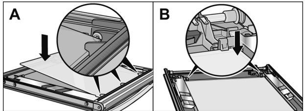
1. Zwischenscheibe in die drei Aufnahmen einsetzen (Bild A).
