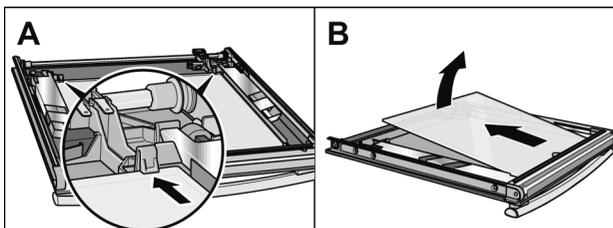
1. Halterungen links und rechts in Pfeilrichtung drücken (Bild A) und die Zwischenscheibe ausrasten.
