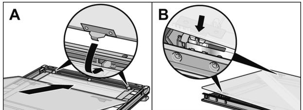
1. Türscheibe in die zwei Aufnahmen einsetzen (Bild A).
