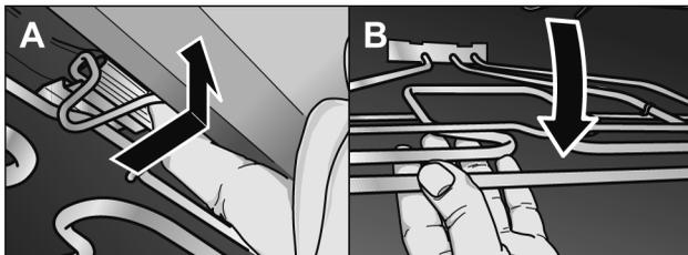
1. Haltebügel des Grillheizkörpers nach vorne ziehen und nach oben drücken, bis der Grillheizkörper hörbar ausrastet (Bild A).
