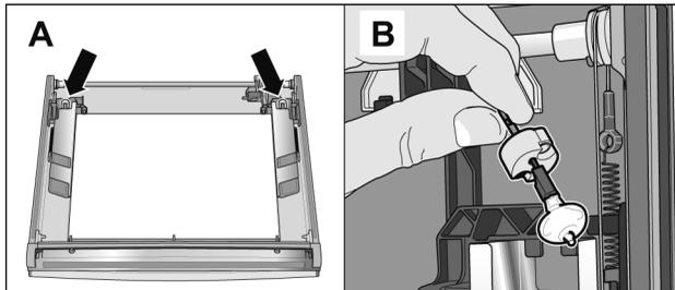
Die Halogenlampen sitzen links und rechts neben der Gerätetüreinhängung (Bild A).
