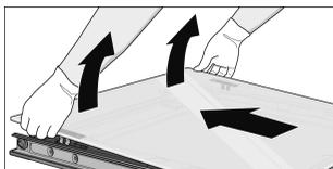
2. Türscheibe an der Einhängung der Gerätetür durch leichtes Anheben ausrasten und herausziehen.
