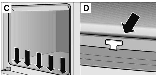
2. Die Haken der Türdichtung (Bild D), an weiteren fünf Stellen (Bild C), durch leichtes Drehen im Uhrzeigersinn aushängen.
