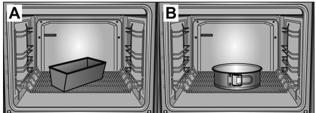
Stellen Sie beim Backen auf einer Ebene mit CircoTherm® Heißluft eine Kastenform immer diagonal (Bild A) und eine runde Backform immer in die Mitte des gekrümmten Rostes (Bild B).
