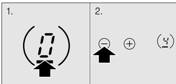
3. Modificare il grado di cottura: Selezionare la zona di cottura e cambiare il grado di cottura con i simboli + o -.
