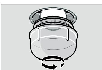
**3.** Backofenlampe durch den gleichen Lampentyp ersetzen.
