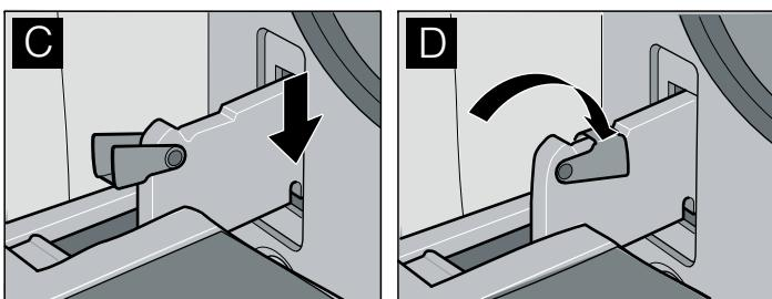
Die Gerätetür ist gesichert und kann nicht mehr ausgehängt werden.
