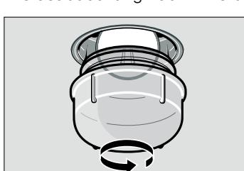
**3.** Backofenlampe durch den gleichen Lampentyp ersetzen.
