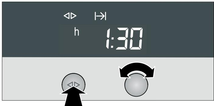
El aparato se apaga automáticamente una vez transcurrida la duración de funcionamiento programada.
