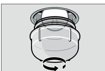
3. Backofenlampe durch den gleichen Lampentyp ersetzen.
