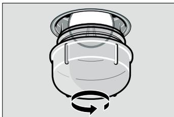
3. Remplacer l'ampoule du four par un type d'ampoule identique.
