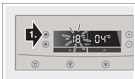
De temperatuurindicatie geeft gedurende 10 seconden de warmste temperatuur aan die in de diepvriesruimte heeft geheerst. Hierna wordt de ingestelde temperatuur weer aangegeven.
