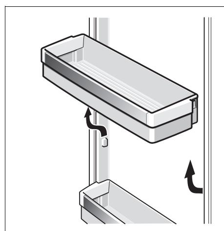
Voorraadvakken in de deur iets optillen en eruit halen.
