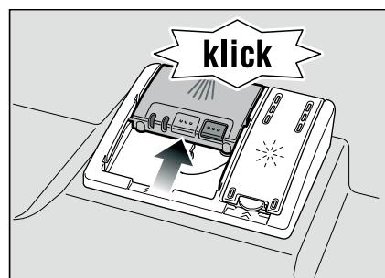
Il contenitore detergente si apre automaticamente in funzione del programma, al momento opportuno. Il detersivo in polvere o liquido si distribuisce nell'apparecchio e si diluisce, la compressa cade nella vaschetta di raccolta compressa e qui si scioglie in modo dosato.
